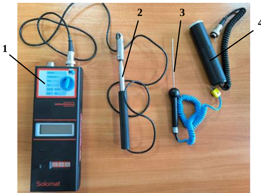
Рисунок 3.7 – Загальний вигляд приладу для вимірювання параметрів середовища Solomat MPM500e: 1 – основний блок приладу Solomat MPM500e; 2 – анемометричний зонд; 3 – температурний зонд; 4 – зонд відносної вологості повітря.
