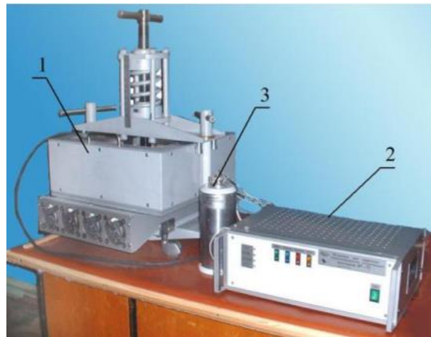
Рисунок 3.3 – Загальний вигляд лабораторної установки для визначення фізико-механічних та теплофізичних властивостей насіннєвої маси люцерни: 1 – теплоізовованні паралелепіеди; 2 – плоский електричний нагрівач; 3, – диференційні термометри
